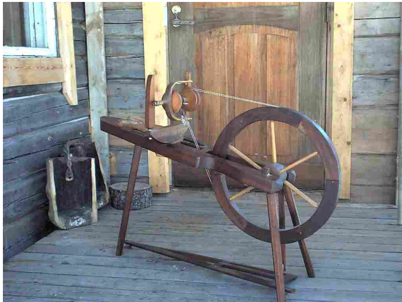
Dieses Spinnrad funktioniert ohne Metall
